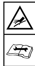
**Leitungen mit Flüssigkeiten, die unter hohem Druck stehen.** Beim einem Bruch der Leitungen auf austretenden Ölstrahl achten.
