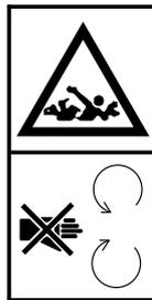
**Danger d'être accroché de l'arbre à cardans.** Il est absolument interdit de s'approcher de l'arbre à cardans en mouvement.
