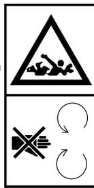
**Gefahr des Hängenbleibens an der Gelenkwelle.** Es ist absolut verboten, sich der laufenden Gelenkwelle zu nähern.
