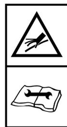
**Tuyaux avec fluides à haute pression.** Faire attention aux jets d'huile en cas de rupture d'un tuyau.
